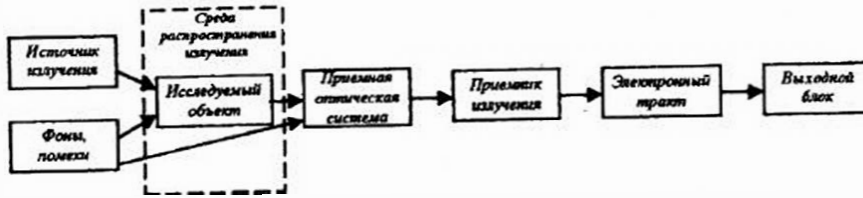
Рис. 1.1. Обобщенная схема работы ОЭП
