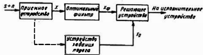
Рис.11.1. Структурная схема системы обнаружения
