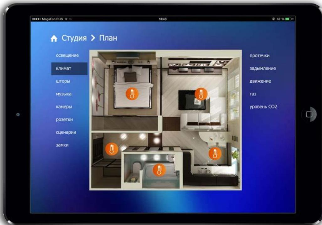
Рисунок 1.4 – iPad визуализация на основе Evika Logic Machine
