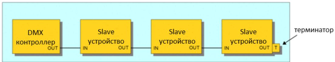
Рисунок 2.25 – Шинная топология DMX512
