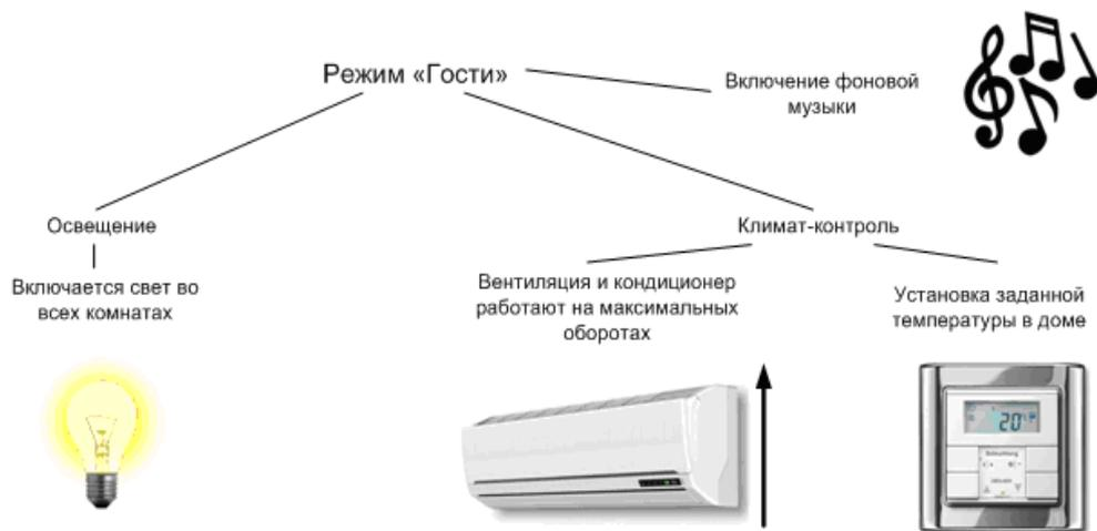
Рисунок 3.6 – Схема работы системы в режиме «Гости»
