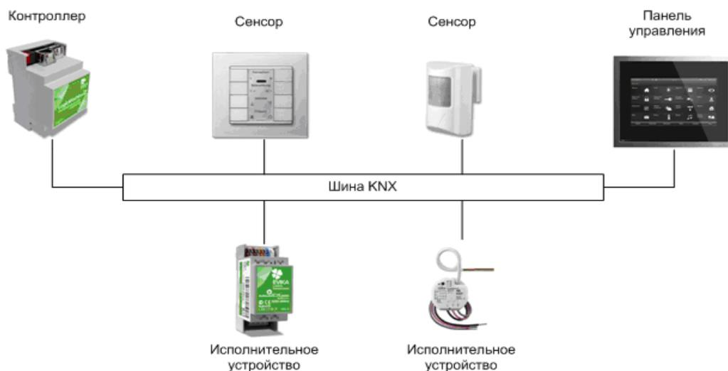
Рисунок 3.1 – Пример соединения устройств в системе KNX
