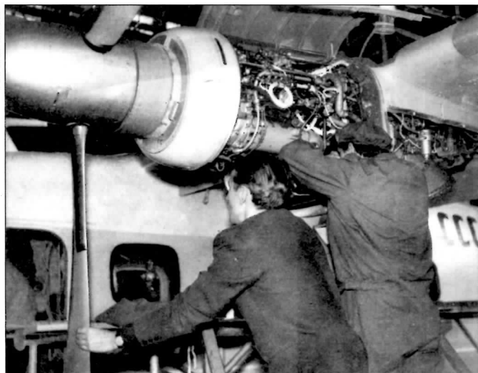
Обслуживание двигателя ГТД-550BC ГТД-550BC engine maintenance
