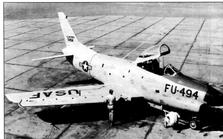
Механики компании «Норт Америкен» снаряжают неуправляемыми ракетами фюзеляжную пусковую установку Fuselage loading case are equipped with unguided rockets by North American company mechanics
