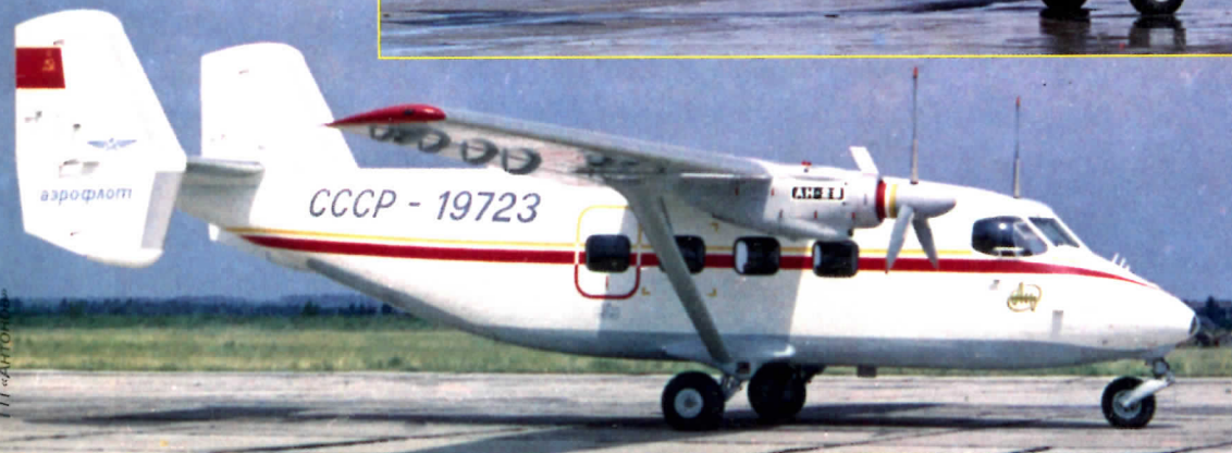
Первый опытный экземпляр Ан-28 (сер. № 01-03) с двигателями ГТД-850. Киев, лето 1973 г. The first prototype of the AN-28 (serial No. 01-03) with GTD-850 engines. Kyiv, summer 1973
