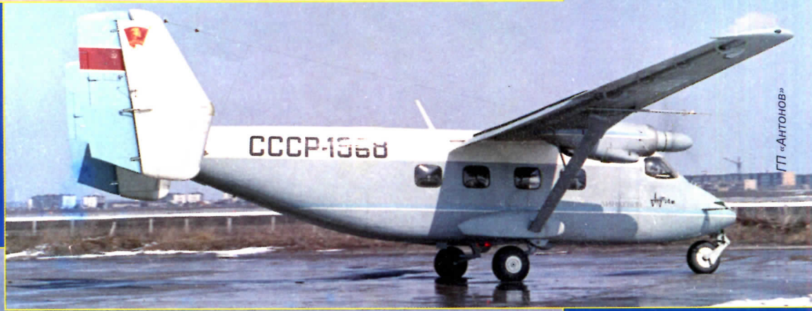
Первый опытный экземпляр Ан-28 (сер. № 01-03) с двигателями ГТД-850. Киев, лето 1973 г. The first prototype of the AN-28 (serial No. 01-03) with GTD-850 engines. Kyiv, summer 1973
