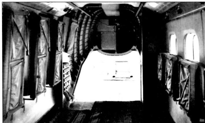
Пассажирские сиденья на Ан-28 легко складывались к бортам Passenger sits of An-28 could be easy folded to the side walls
