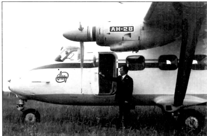
Передняя дверь — особенность опытных самолетов Ан-28 Front door is a feature of the An-28 prototypes
