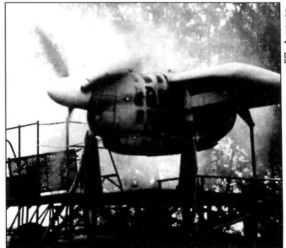
Испытания двигателя ТВД-105 на «горячем» стенде
