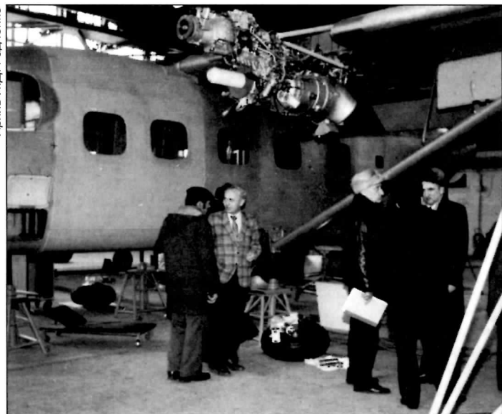
Специалисты ОКБ Антонова inspectируют сборку первого серийного Ан-28. Мелец, поздняя осень 1983 г.
