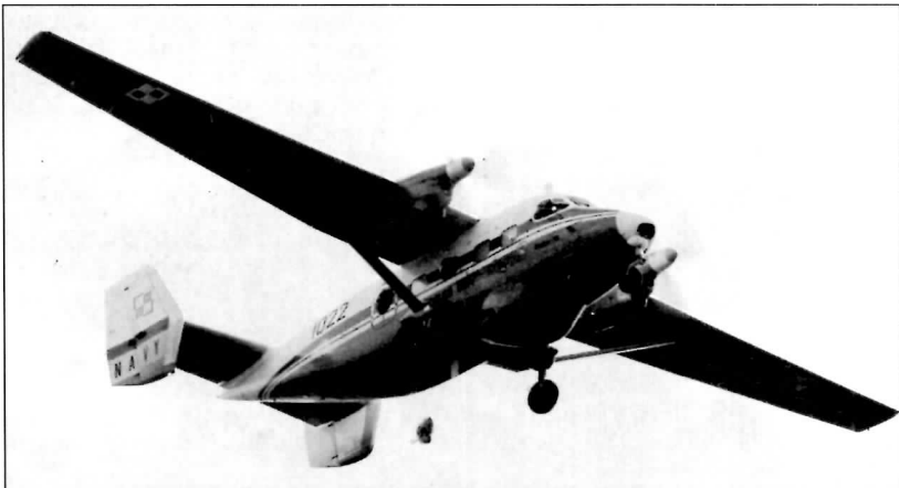
Поисково-спасательный самолет Ан-28RM (зав. № AJG001-01), дооснащенный до стандарта M 28B1R. 16 сентября 2011 г. An-28PM search&rescue aircraft equipped to M 28B1R standard. September 16, 2011
