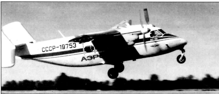
Отработка взлета с имитацией отказа левого двигателя Taking off with imitation of engine failure drill
