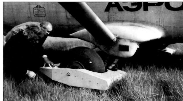
Во второй половине 1980-х годов на первом серийном Ан-28 (зав. № 1AJ001-01) отработывали колесно-лыжное шасси, предназначенное для улучшения проходимости самолета по размокшим аэродромам
