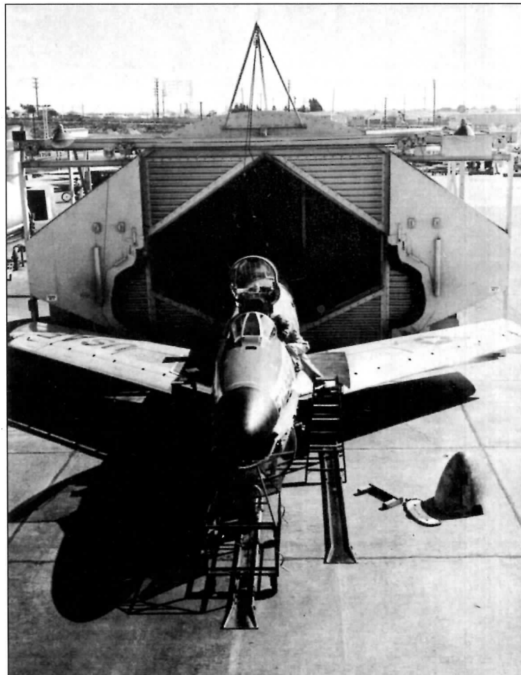
Испытания двигателя серийного перехватчика F-86D на специальном стенде компании «Норт Америкен»
