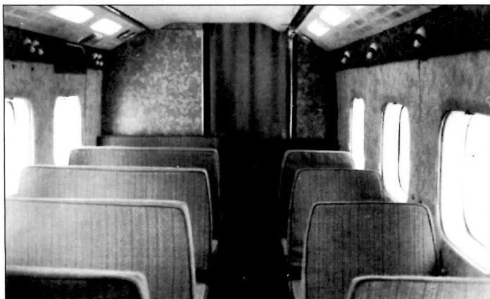
Пассажирские сиденья на Ан-28 легко складывались к бортам Passenger sits of An-28 could be easy folded to the side walls
