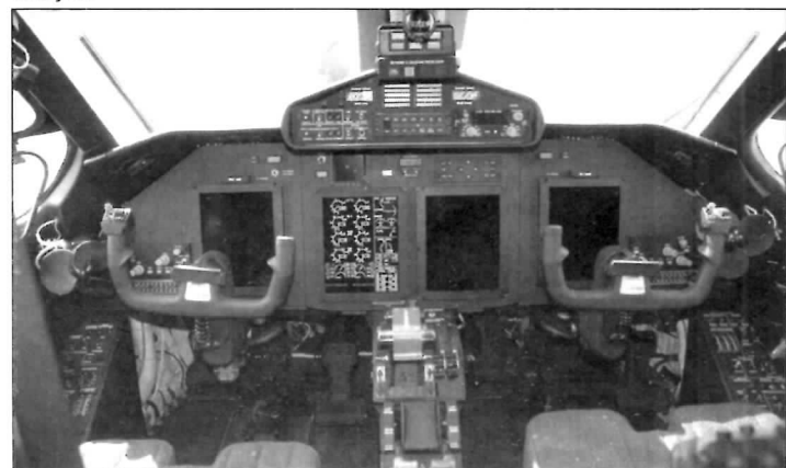
Приборное оборудование кабины экипажа Ан-28 (слева — тензостурвал) и М 28В/РТ Avionics in the An-28 and M 28B/PT cockpit
