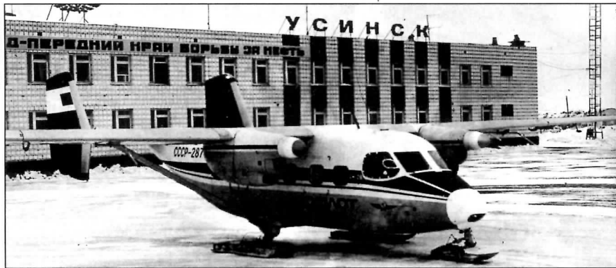
Серийный Ан-28 (борт СССР-28745) в ходе испытаний лыжного шасси. Начало 1988 г.
