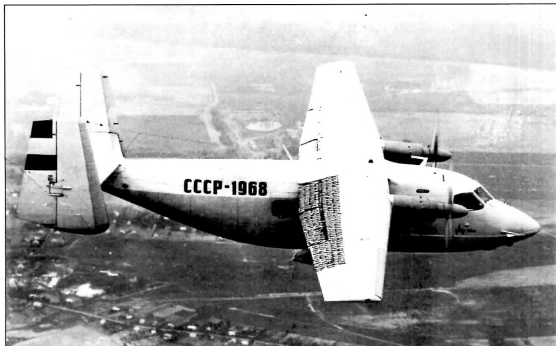
Ан-14М в испытательном полете. Для исследования обтекания верхней поверхности крыла наклеены шелковинки. Лето 1969 г. The An14M during a test flight. Tufts were pasted to the top surface of the wing for research of streamlining. Summer 1969
