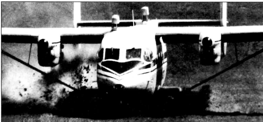
Испытания на аэродромах с различной прочностью грунта были важной составляющей программы тестирования Ан-28 Testing on airfields with different soil strength was important part of testing program of the An-28
