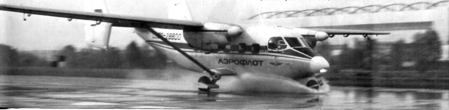
Во второй половине 1980-х годов на первом серийном Ан-28 (зав. № 1AJ001-01) отработывали колесно-лыжное шасси, предназначенное для улучшения проходимости самолета по размокшим аэродромам
