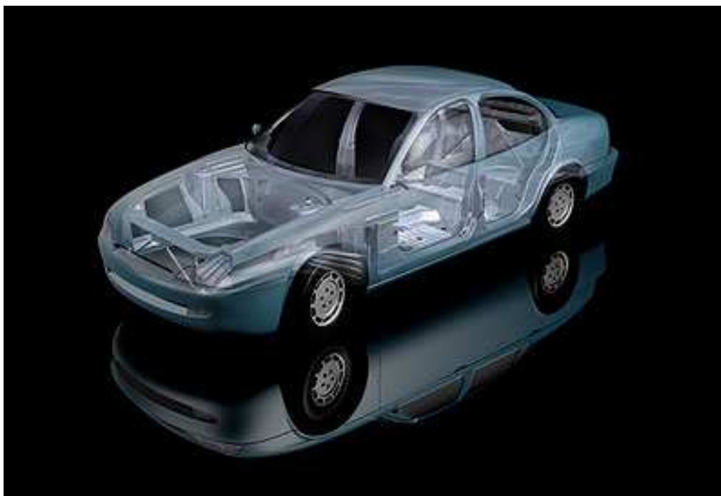
Рис. 5.4. Экспериментальный автомобиль с кузовом изготовленным по технологии ULSAB
