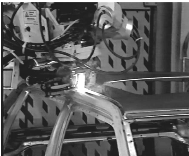
Рис. 4.5. Соединение крыши с боковиной кузова лазерной сваркой
